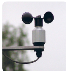
Fig. 5 Anemometro, strumento per determinare la velocità e la direzione del vento
